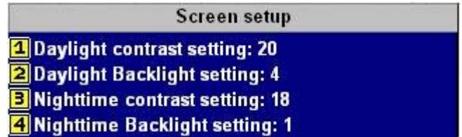
Le niveau de luminosité a une incidence directe sur la consommation électrique de votre instrument. Ne pas utiliser de réglage supérieur à ce qui est nécessaire pour une bonne visibilité dans votre aéronef.
